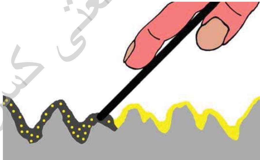
شکل سه: جذب روغن موجود در سطح توسط پوشش و تماس مستقیم پوشش با مخزن
