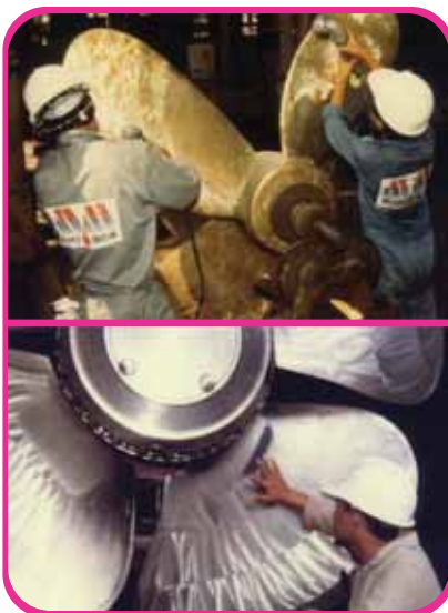
تعمیر و بازسازی پروانه برنزی با استفاده از Ceramium
