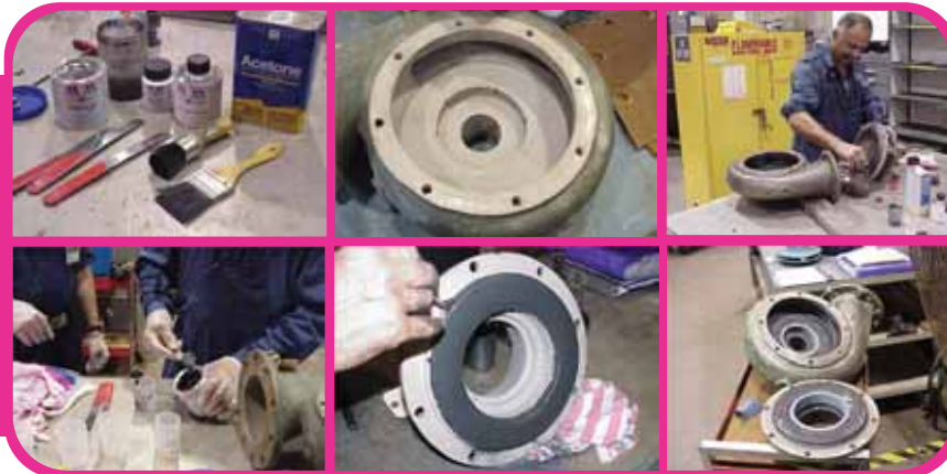
تعمیر بدنه‌ی فرسوده‌ی یک پمپ با استفاده از اعمال Ceramium
